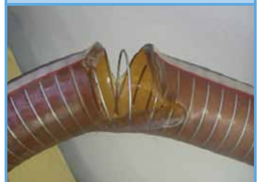
油圧ホースの損傷例
